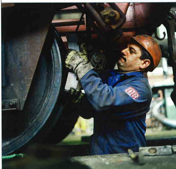
BILD 1: Umrüstung der Güterwagenflotte auf Verbundstoffbremssohlen als wichtiger Beitrag zur Lärminderung
