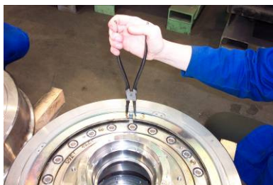
Abb.4 Ringabsorber (DAAVAC) mit einfacher Montage
