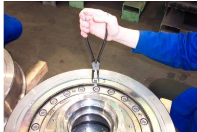
Abb.4 Ringabsorber (DAAVAC) mit einfacher Montage
